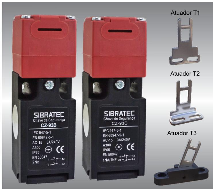
As chaves de segurança Sibratec modelo CZ-93B e CZ-93C são ideais para proteções de acesso a locais de risco para o operador, como em painéis energizados. O sistema da chave permite que só o atuador possa acioná-la e reiniciar o equipamento somente quando a porta estiver fechada novamente.
