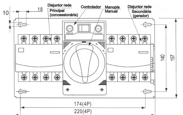
As chaves de transferência automática rede/gerador HYCQ5 possuem todos os requisitos de confiabilidade e segurança na comutação de redes de energia: rede pública/gerador ou vice-versa, podendo ser manobradas com carga. Possuem manopla para transferência manual caso seja necessário. Além da função de comutação, possui a proteção de circuitos elétricos em condições normais de sobrecarga e curto-circuitos.
